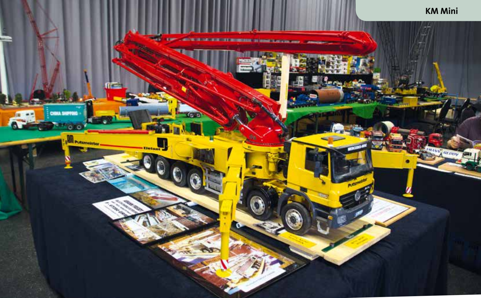
Freddy Amann sorgte mit seiner Putzmeister-Betonpumpe M 63 5 für ein Highlight auf der Mini-Bauma. Das Modell im Maßstab 1:8 ist komplett in Handarbeit entstanden und wiegt circa 85 kg. Das Modell ist 1.970 mm lang, 325 mm breit und 505 mm hoch. Verwendet wurde Kunststoff, Stahl, Alu, Messing und PVC. Zudem wurden Kugellager, Zahnräder und vier elektronische Module verbaut. Das Modell ist voll funktions- und fahrfähig.
