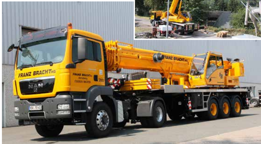
Vorne ein 2-achsiger 18-Tonner, hinten ein 3-achsiger Kranauflieger: so geht's genehmigungsfrei auf die Straße. Der GSK55 hat sich bei Bracht bereits im Einsatz bewährt – nun folgte der 2.
