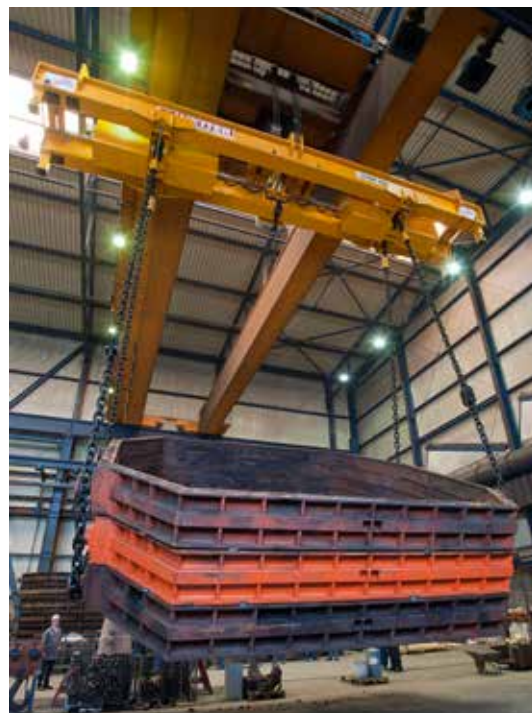
Das gelieferte Rotomax-Lastwendegerät ist für Ausnahmelasten von bis zu 135 t ausgelegt.
