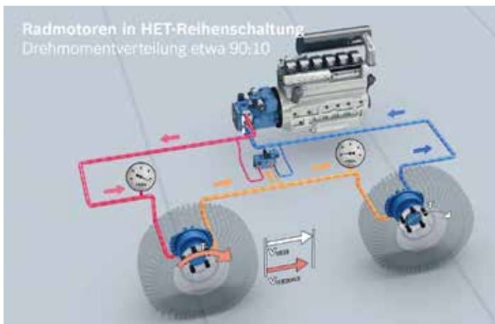
HET wechselt vollautomatisch vom Zwei-Rad- zum Allrad-Antrieb.
