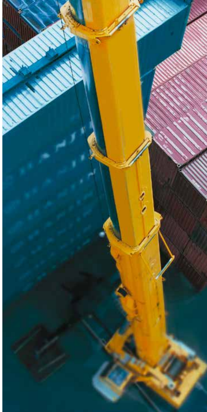
Leicht, tragfähig, flexibel – das sind die wichtigen Kriterien des XABO Sonderbaustahls von ThyssenKrupp Steel Europe. Das hochfeste Material hält dynamischen Belastungen, zum Beispiel in Teleskopauslegern von Mobilbaukränen, stand und ermöglicht so ein punktgenaues Manövrieren von schweren Lasten. So wird das Material zur ersten Wahl beim Bau von Wolkenkratzern wie beispielsweise dem Burj Khalifa in Dubai.
