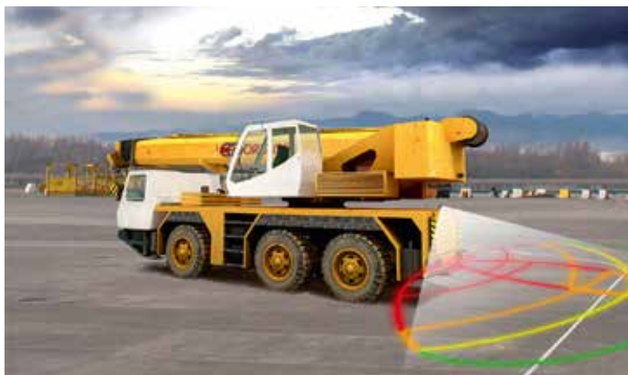
Orlaco zeigt Kamera-Monitor-Systeme mit Radar.
