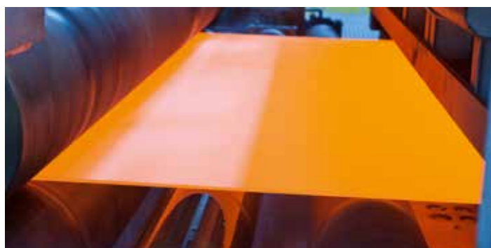
NLMK Clabecq hat 100 Millionen Euro in eine neue Vergütungsline investiert. Hier soll in den nächsten Wochen unter anderem die Herstellung von Quend 960 anlaufen. Die Stahlgüte mit einer Mindeststreckgrenze von 960 MPa wird zum Beispiel für Teleskopausleger von Kranen verwendet.
