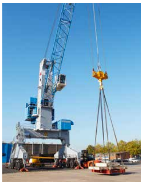
Modell 2 Hafenreifenportalkran während der Testphase bei Terex Port Solutions, Deutschland. Bilder: Terex
