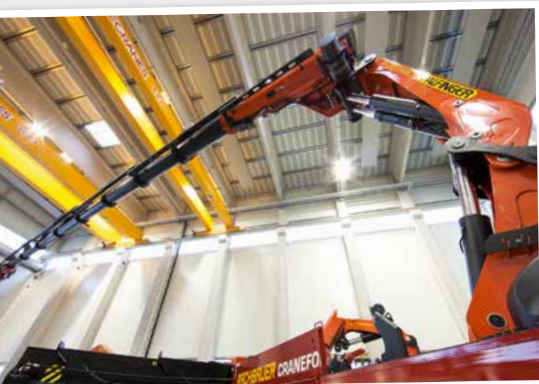
Ganz bewusst hat sich Palfinger beim 200 mt-Kran für das Langarmkonzept entschieden.
