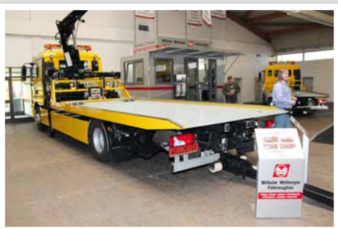
Der LFBK ist das Basisfahrzeug im Abschleppbetrieb. Der MAN TGM 15.250 mit einem Aufbau des Herstellers Wellmeyer mit einer Nutzlast laut Herstellerangabe von 4.860 kg.
