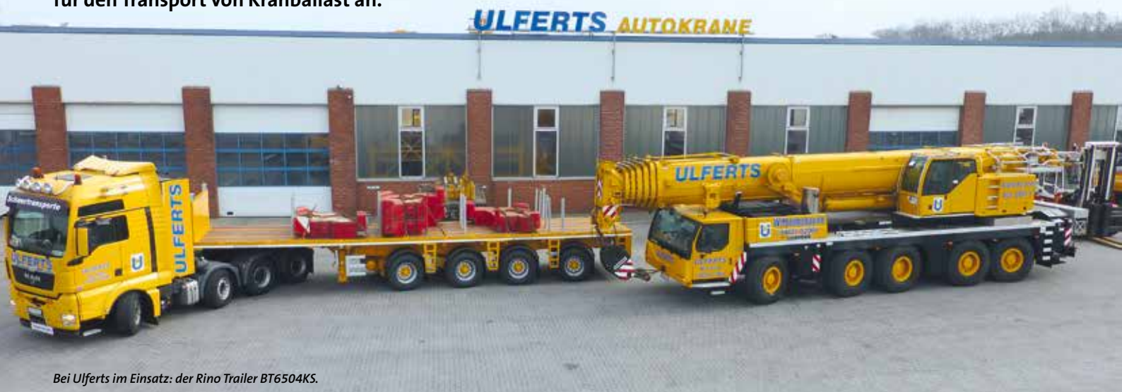
Der Rino Trailer BT6504KS ist ein robuster Ballasttrailer mit 54 t Nutzlast.
