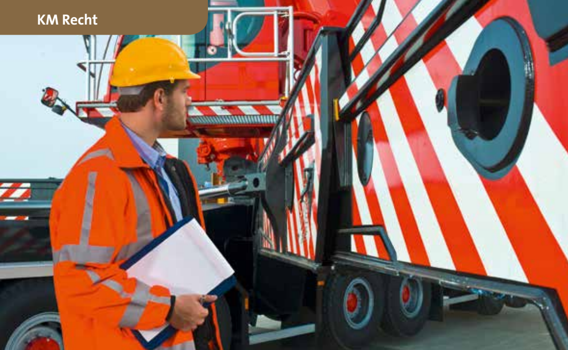
Entsprechend des Rüstzustandes des Krans muss die LMB programmiert werden.
