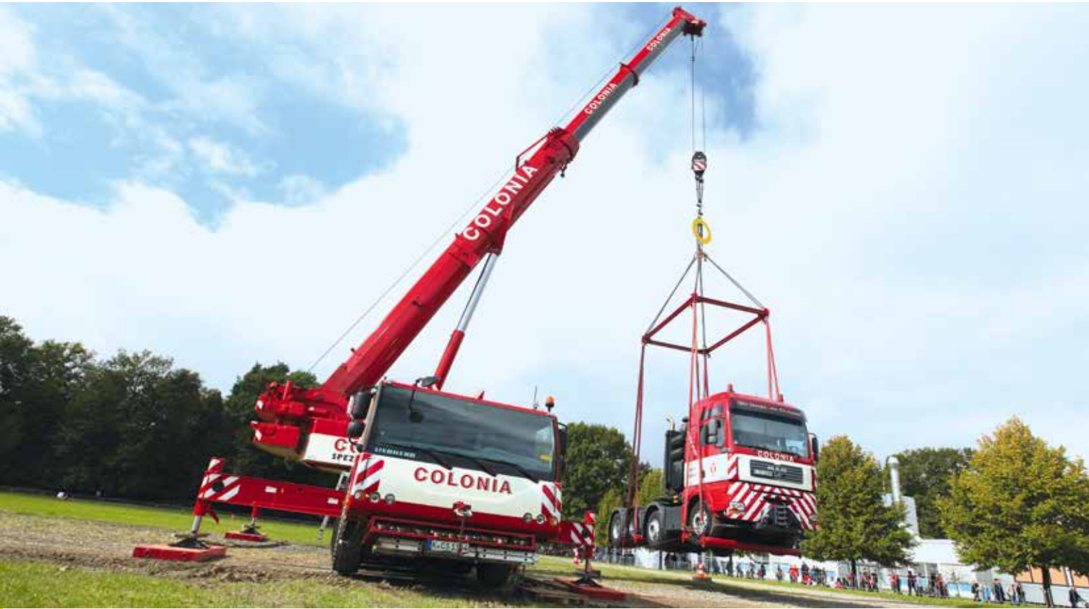
Die 16 t schwere Zugmaschine hängt an den geklebten Stahlzylindern in einem Meter Höhe.
