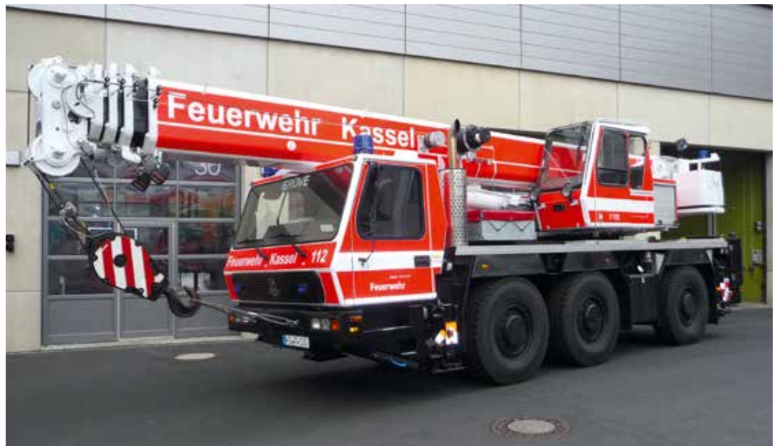
Wurde feuerwehrtauglich umgebaut: ein zehn Jahre alter Grove GMK 3050.
