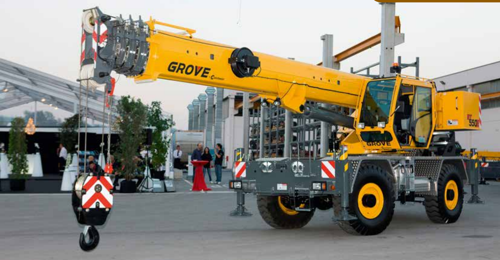
Mit dem Grove RT550E hat Manitowoc auf der bauma einen RT-Kran im 55-t-Segment präsentiert, der ohne größeren Transportaufwand über europäische Straßen befördert werden kann.
