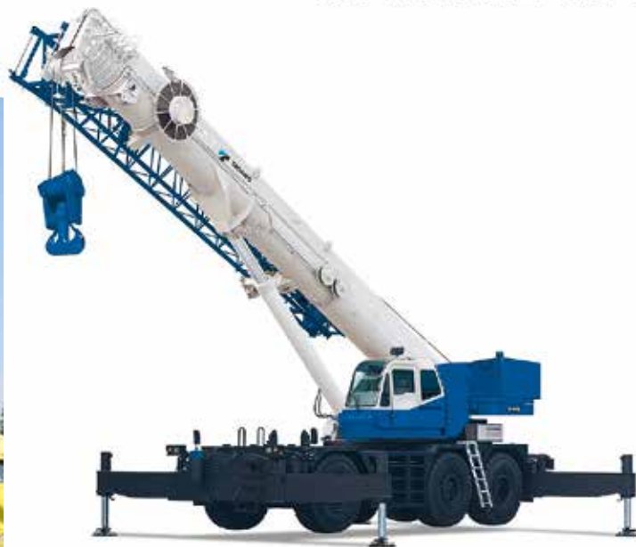
Tadano bietet in seinem Produktprogramm sowohl Teleskopraupen – Tadano Mantis – als auch RT-Krane. Der GR-1450EX, der im August vorgestellt wurde, ist dabei das Flaggschiff der Tadano-RT-Palette und bietet eine maximale Tragkraft von 145 t.
