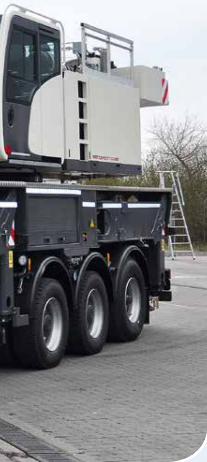
Aus einem Serien-Vierachs-Fahrgestell von Mercedes-Benz entsteht bei Paul Nutzfahrzeuge Special Trucks & Chassis in Passau in wenigen Wochen ein Fünfachs-Fahrgestell mit der Bezeichnung Mercedes-Benz Actros 5548 10x4/6.
