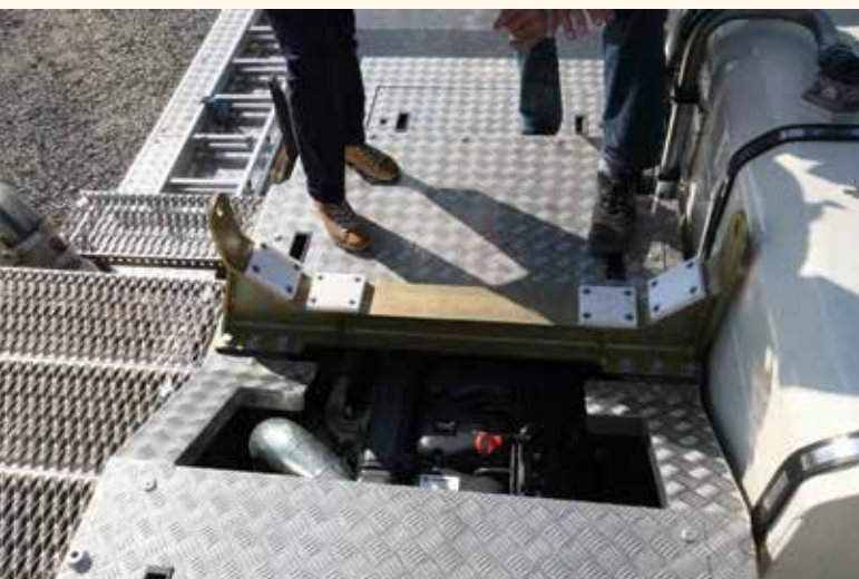
Gut zugänglich: Der Motor sowie die zur Erfüllung der unterschiedlichen Abgasnormen notwendigen Komponenten (links unter den Lochblechritten), die so jederzeit ab- oder nachgerüstet werden können. KM-Bild
