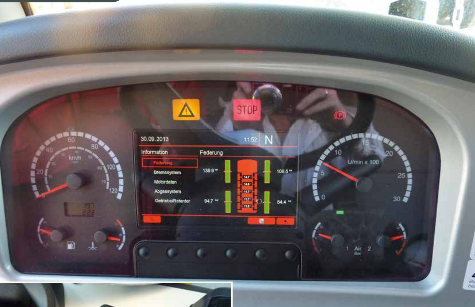
Das Cockpit des Explorer 5800: In die einzelnen Menüs gelangt man über den rechts am Fahrersitz befindlichen Drehknopf. Im Bild: Anzeige der Stellung der hydraulischen Federn inklusive der Achslasten. KM-Bilder
