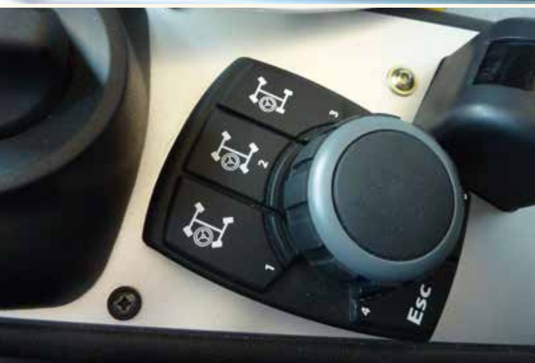
Das Cockpit des Explorer 5800: In die einzelnen Menüs gelangt man über den rechts am Fahrersitz befindlichen Drehknopf. Im Bild: Anzeige der Stellung der hydraulischen Federn inklusive der Achslasten. KM-Bilder
