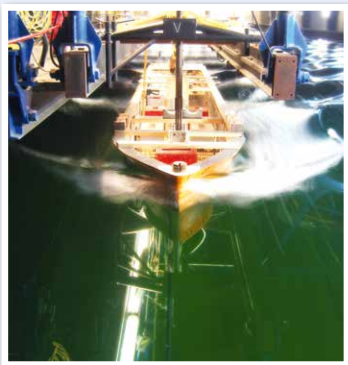
Prüfung maßstabsgetreuer Schiffsmodelle im Schlepptank.
