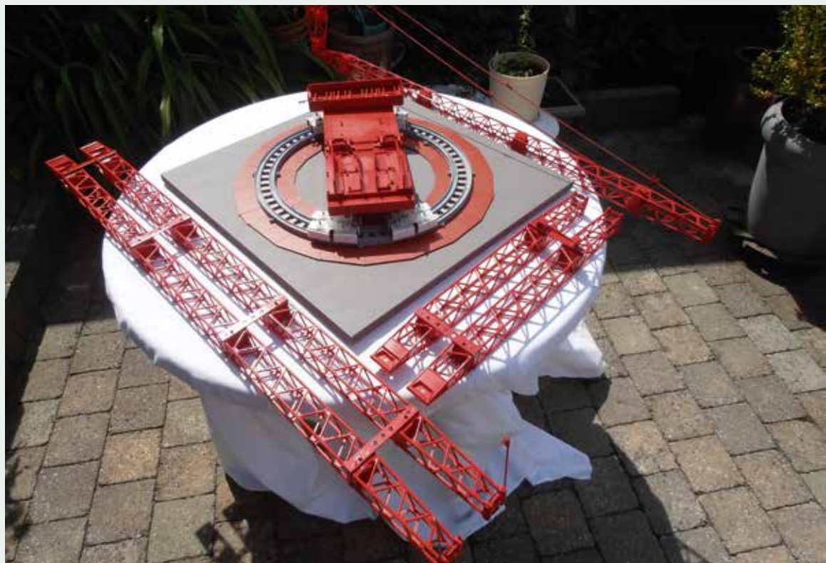
Fertig für die Endmontage: Twin-Hauptausleger, Twin-Gegenausleger sowie die Verlängerung liegen zum Aufbau bereit.
