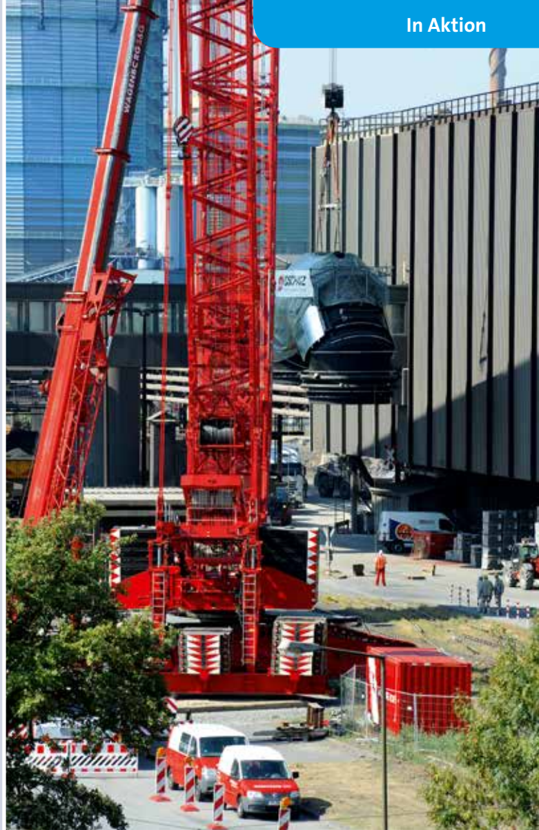
Der LR 1750 kam mit bis zu 320 t Superliftballast zum Einsatz.
