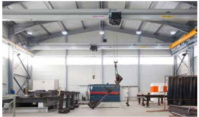
Der 10.000ste Kranauftrag der Eurofactory ging ins Ruhrgebiet: In der neuen Produktionshalle eines Rohrleitungs- und Stahlbauunternehmens sind jetzt zwei CXT NEO Einträgerbrückenkrane mit jeweils 10 t Tragfähigkeit im Einsatz.
