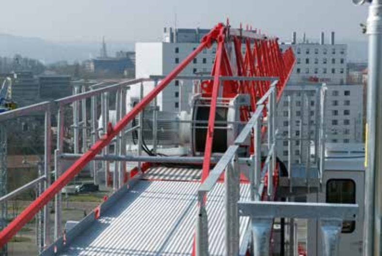
Der neue Wolff-Kran ermöglicht Auslegerlängen zwischen 25 m und 50 m, die in 2,5 m-Schritten erweitert werden können.
