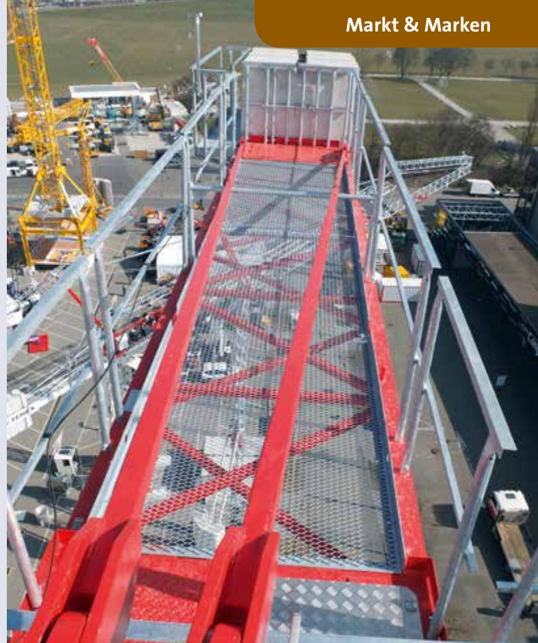
Der Gegenausleger ist mit einer durchgängigen Lauffläche ausgestattet, was den Zugang zu den Gegengewichten komfortabel und sicher macht.
