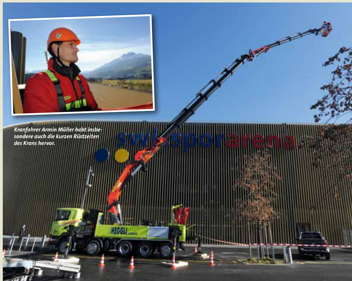
Ein Palfinger PK 200002 L SH auf einem 5-achsigen Scania Fahrgestell – das ist schon ziemlich einmalig.
