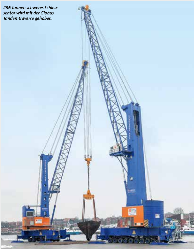
Die Globus-Tandemtraverse, gehoben von den beiden Terex Gottwald Hafemobilkränen.
