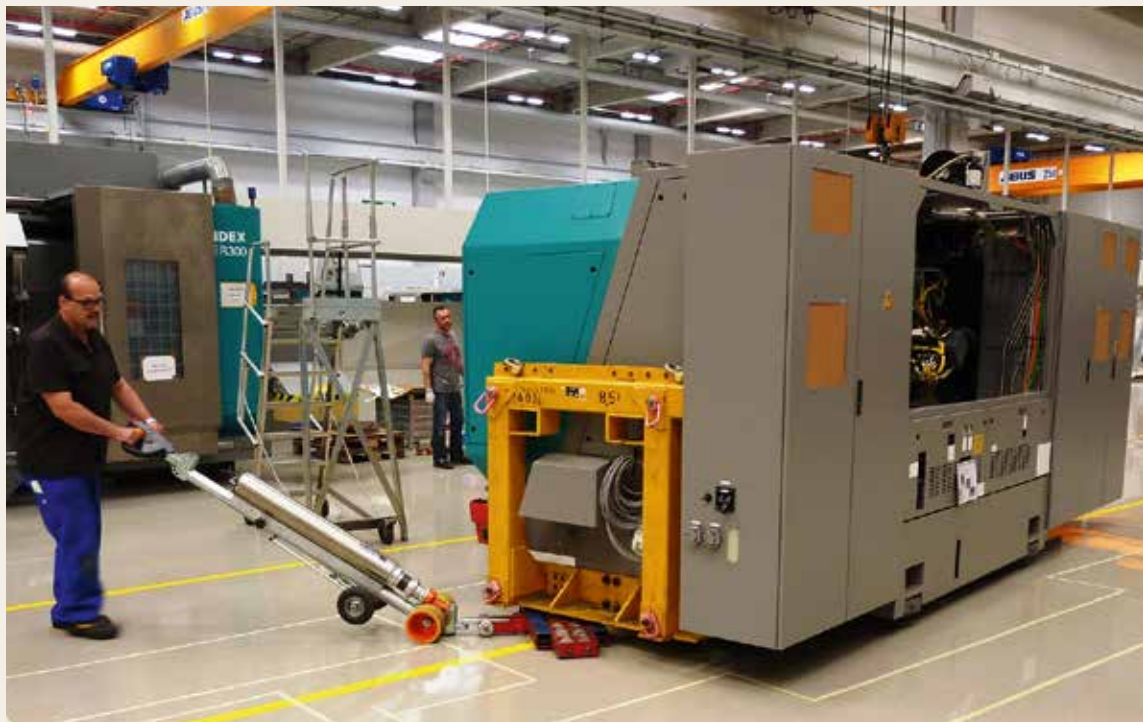
Hat sich als Transportmittel bei innerbetrieblichen Montagen bewährt: PowerAttack.
