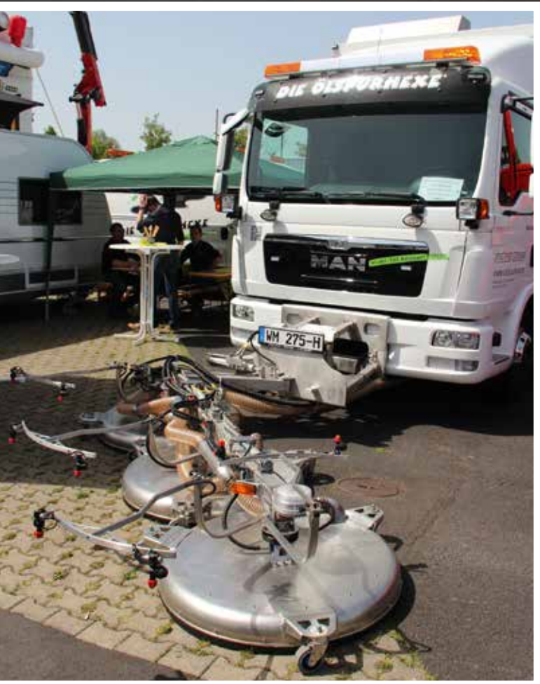
Die fachgerechte Ölspurbeseitigung auf Verkehrsflächen bildet einen festen Themenblock – hier die „Ölspurhexe“ aus dem Hause Wehner.
