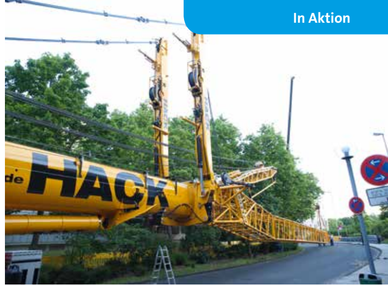
Die Schwierigkeit bei diesem Einsatz war, dass es nicht genügend Platz gab, die Wippe komplett am Boden zu montieren. Bilder: Timo Süß
