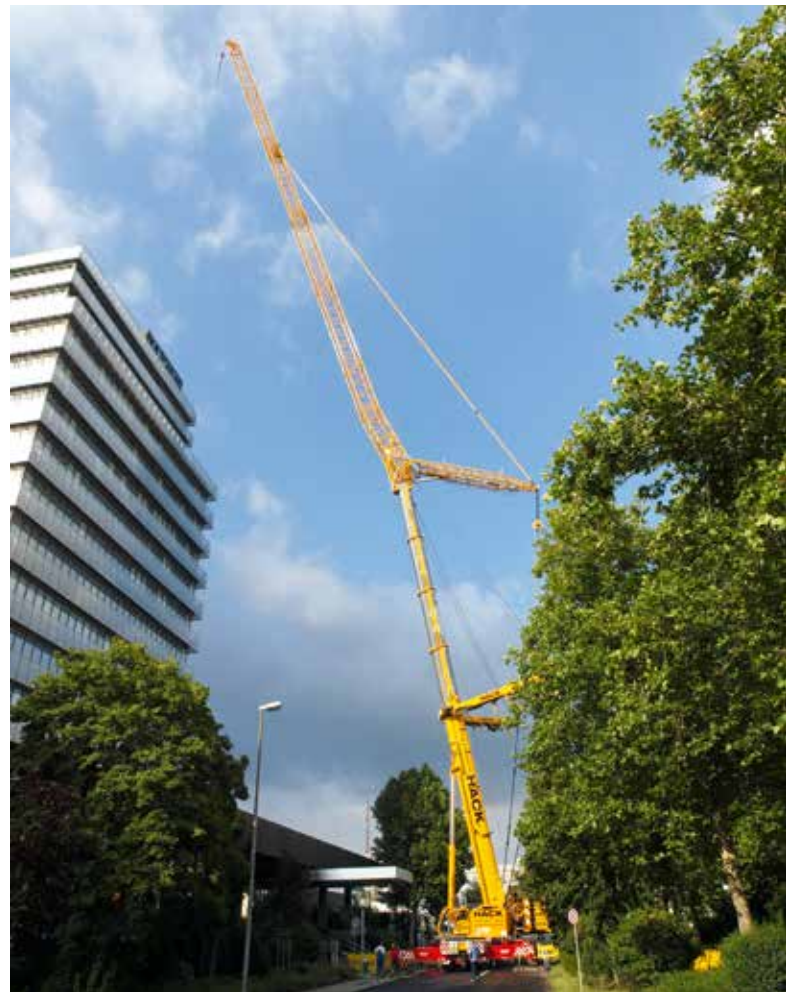
Die Schwierigkeit bei diesem Einsatz war, dass es nicht genügend Platz gab, die Wippe komplett am Boden zu montieren. Bilder: Timo Süß
