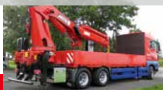
MAN-3-Achs-LKW, Typ TGX 26.440 6x4 BL, mit MKG-Ladekran HLK 591
