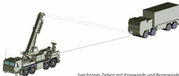
Synchrones Ziehen mit Kranwinde und Bergewinde.
