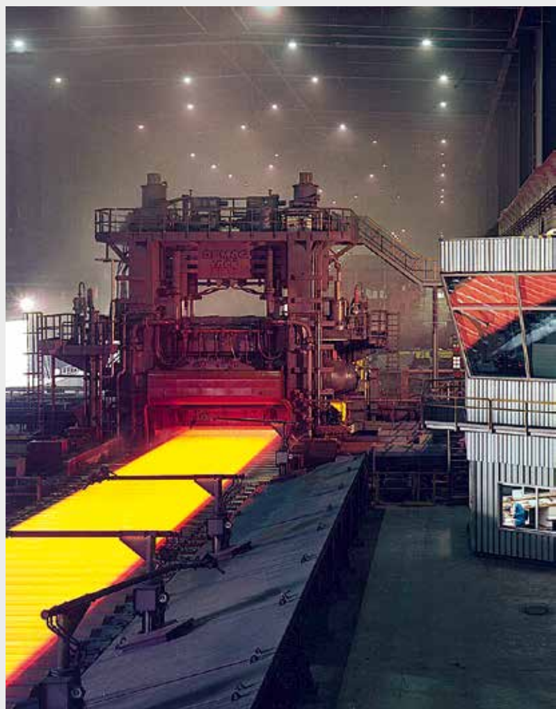
Das Dillinger Walzgerüst ermöglicht es, sehr breite Bleche und hohe Stückgewichte zu fertigen.
