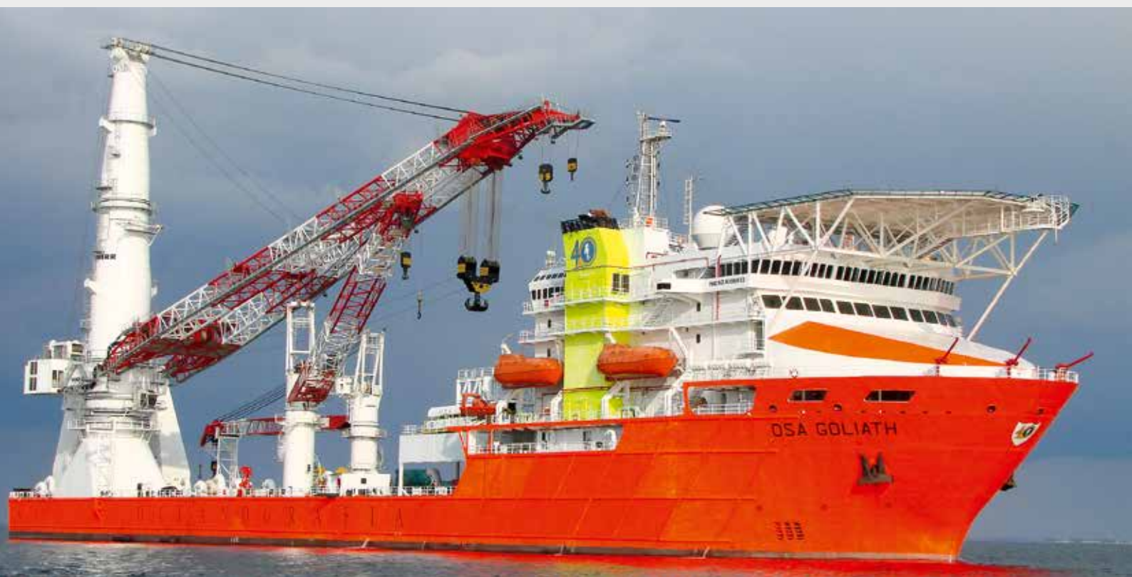
Offshore-Schwerlastkran von Liebherr vom Typ MTC 78000 auf der OSA Goliath.
