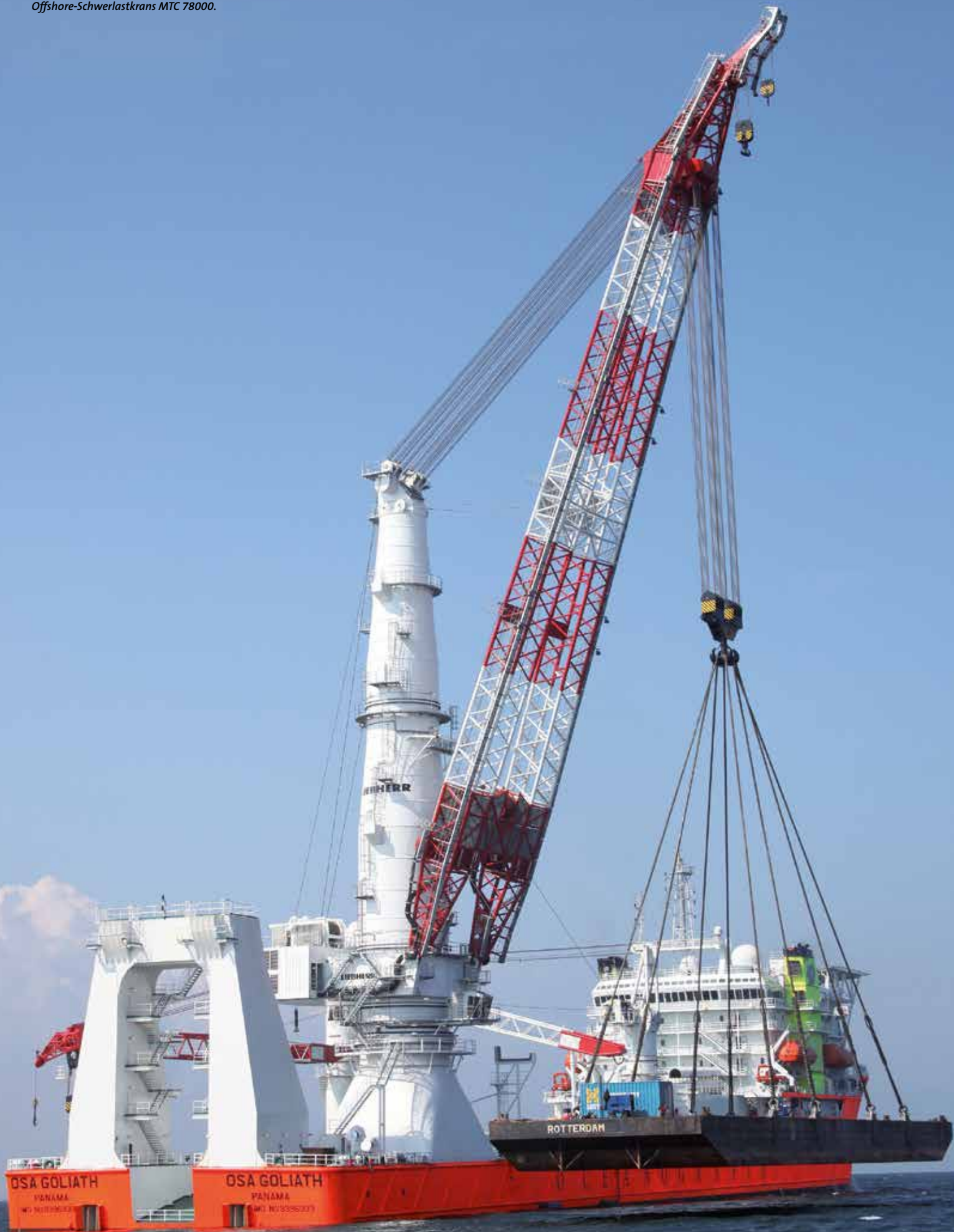
Ausgefahrener Gittermastausleger des Offshore-Schwerlastkrans MTC 78000.
