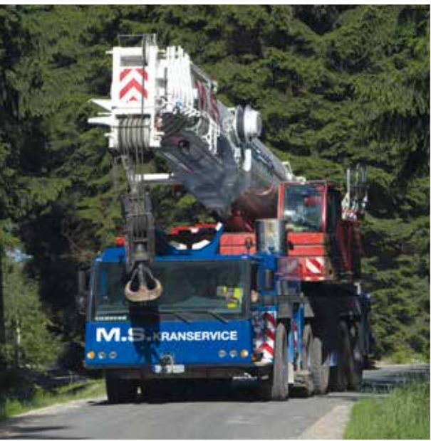
Tele-Krane als Allrounder: Von einer Baustelle zur nächsten – rüsten, nachführen und was sonst noch anfällt ...
