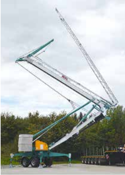
Der neue CM 271 hebt im 2-Strang-Betrieb bis zu 2,2 t und eine Spitzenlast von 0,7 t.
