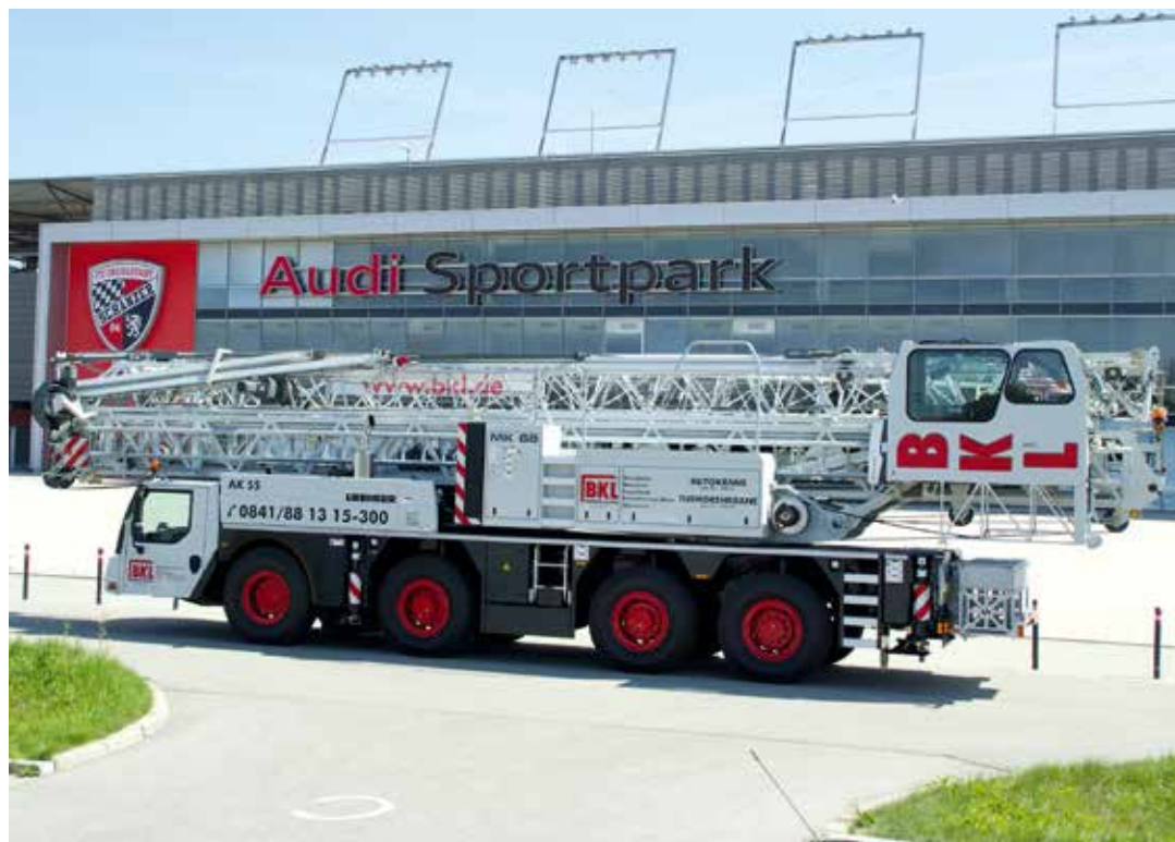
Der Liebherr-Mobilbaukran MK 88 „Plus“ bietet erhöhte Traglast und wurde am BKL-Standort Ingolstadt in Dienst gestellt.
