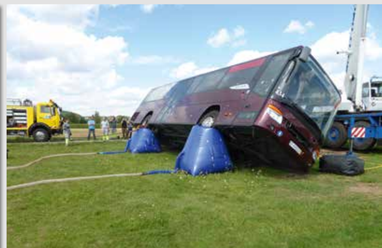
Bei der Bergung eines Busses muss durch die Bauweise besonders darauf geachtet werden, dass mögliche Bergungsschäden vermieden werden.
