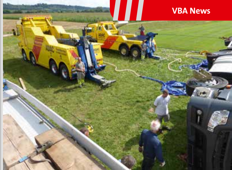
Für die Bergungseinsätze im Schwerverkehr ist ein AWU (Abschleppwagen-Unterfahrlift) erforderlich.
