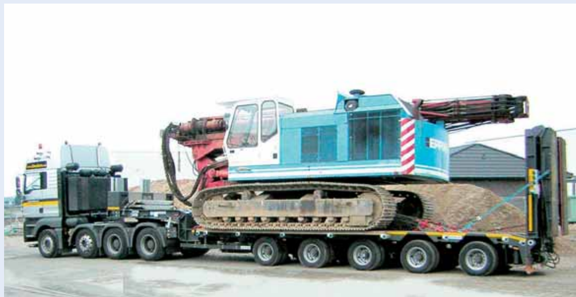
Dieser ausziehbare 5-Achs-Tieflade-Sattelanhängen wurde mit einer verstärkten Rahmenausführung versehen, die eine Punktlast von 54 t auf 5 m bietet. Somit können auch schwere Jungs sicher transportiert werden.
