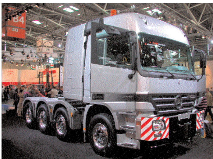
Das schwerste Kaliber aus der Mercedes-Benz-Actros-Familie ist der Actros SLT (SLT = Schwerlast-Transporter). Zusammen mit den Schwerlast-Experten von Titan entwickelten die DaimlerChrysler-Ingenieure die wahlweise 3- oder 4-achsige Zugmaschine für ein Lastzug-Gesamtgewicht von 250 t. KM-Bild
