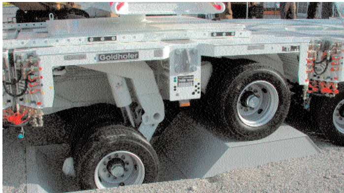
Schwerlastmodul von Goldhofer. Gut zu sehen: der Achsausgleich der Pendelachsen. KM-Bild
