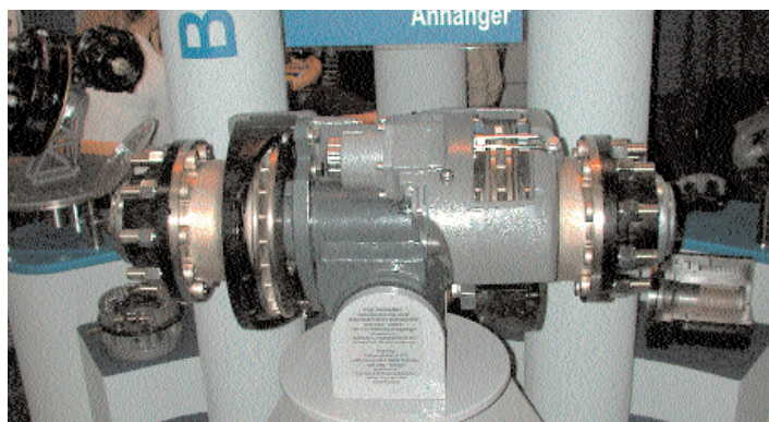
Knott macht die (Scheiben)bremsen. Unter anderem auch für 8 t-Pendelachsen mit 17,5"-Bereifung. KM-Bild
