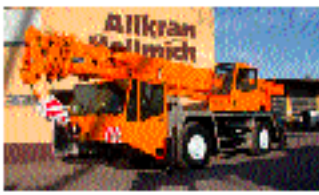
Demag AC 36, 35 t, Bj. 1999, 32 m
