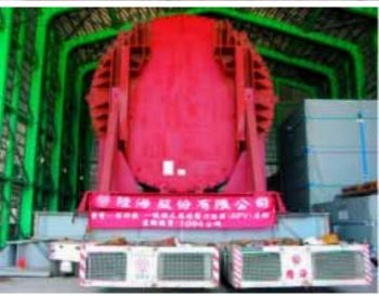
Achslinien der Schwerlastbaureihe THP/ SL des Herstellers aus Memmingen ergänzt wurden. Zusätzlich wurde diese Kombination durch eine 20-achsige Splittversion erweitert.
