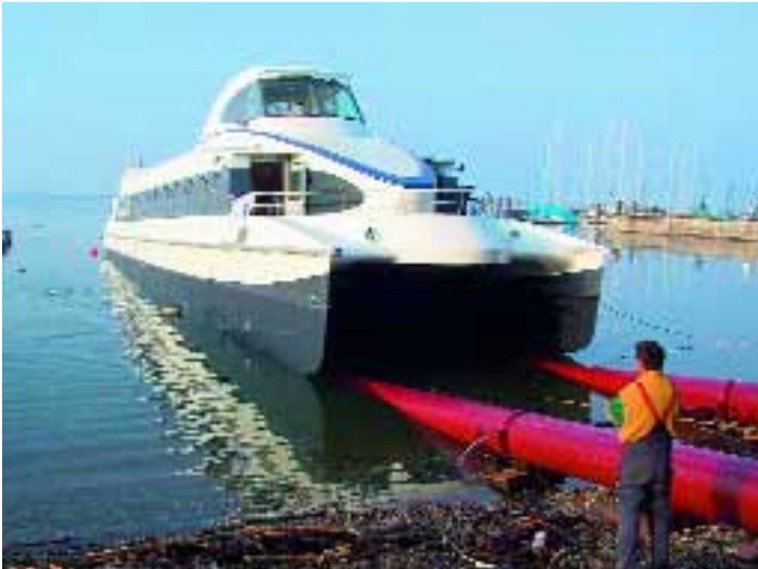
Die neue Slip-Bahn von Kübler kam bereits am Bodensee zum Einsatz. Der komplette Stapellauf der zwei Katamarane war inklusive Transport mit Tieflader in 2 Tagen erledigt.
