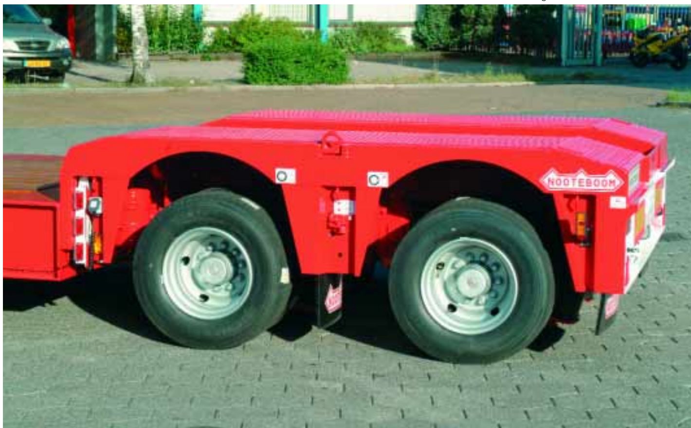
Sorgen für mehr Ladefläche im Tiefbett: Der offene Schwanenhals und das extrem kompakte Achsaggregat.
