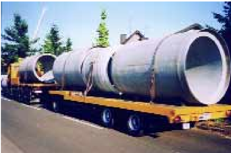
Gefährlicher Leichtsinnsinn: Je ein Gurt oder eine Kette pro Betonrohr kann die Ladung weder längs noch quer halten. Dabei sind derartige Ladungen verhältnismäßig einfach zu sichern. Das dokumentiert auch das Ladungssicherheitshandbuch, das die Transportversicherer im Gesamtverband der Deutschen Versicherungswirtschaft erstellt haben. Gleichzeitig zeigt es viele Mängel bei der Ladungssicherung sowie deren Behebung.
