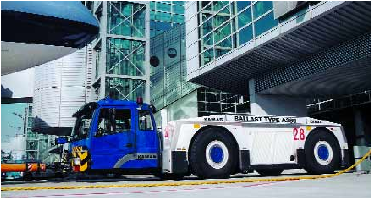
Der Kamag TowBear im Einsatz. Aufgrund des modernen Ballastsystems ist er auch für den A 380 geeignet.
