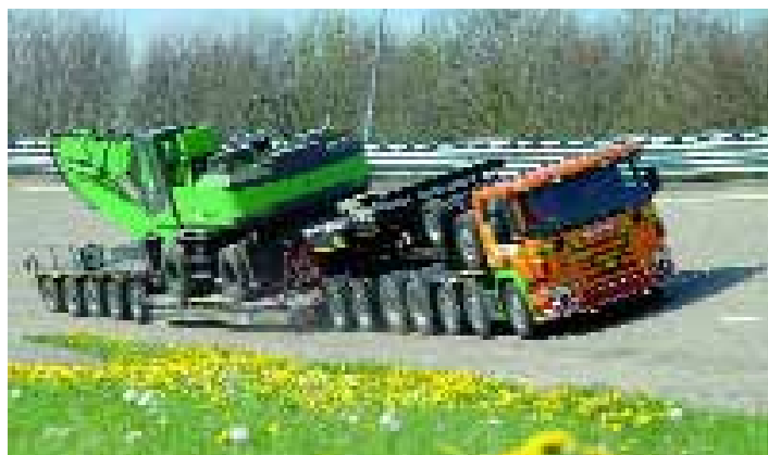
Je nach Ausführung bietet der Pendel-X Eurotieflader laut Hersteller eine höhere Nutzlast bis zu 107 t, abhängig nach Land und den dortigen gesetzlichen Vorschriften.
