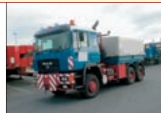
Pos. 2533: MAN-3-Achs-SZM, Typ 33.502 6x6, EZ 07/1996, ca. 191.365 km, gr. Fahrerhaus, WSK, ABS, 600 l Tank, Ballastbrücke ca. 3.900 x 2.500 x 1.800 mm
