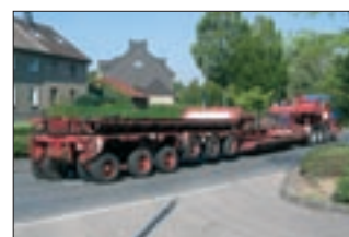
10 x 12 t Scheuerle-Pendelachsen mit 35 t und 60 t Kesselbrücke, Baggerbett, Flachbett und diverserem Zubehör
