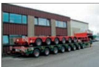
3- bis 8-achsige Satteltiefliader, einfach, doppelt und dreifach teleskopierbar, hydr. oder nachlaufgelenkt
