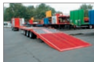
3- und 4-Achs-Megatrailer, teleskopierbar, nachlauf- oder hydr. zwangsgelenkt, Ladehöhe ca. 1.040 mm, in verschiedenen Ausführungen lieferbar
