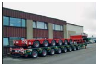
3- bis 6-achsige Satteltiefvlader, einfach, doppelt und dreifach teleskopierbar, hydr. oder nachlaufgelenkt
