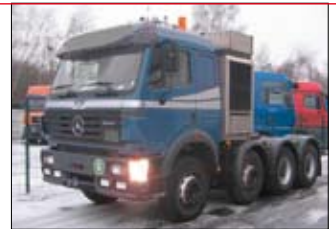
Pos. 3078: Daimler-Benz-4-Achs-SZM, Typ 3553 S 8x4/4, EZ 05/98, WSK, ABS, ZGG 120 t, Standheizung, Klima, Differentialsperre
