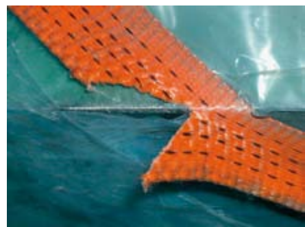
Ein kleiner Riss kann sich schnell weiter entwickeln. Was war hier falsch?
