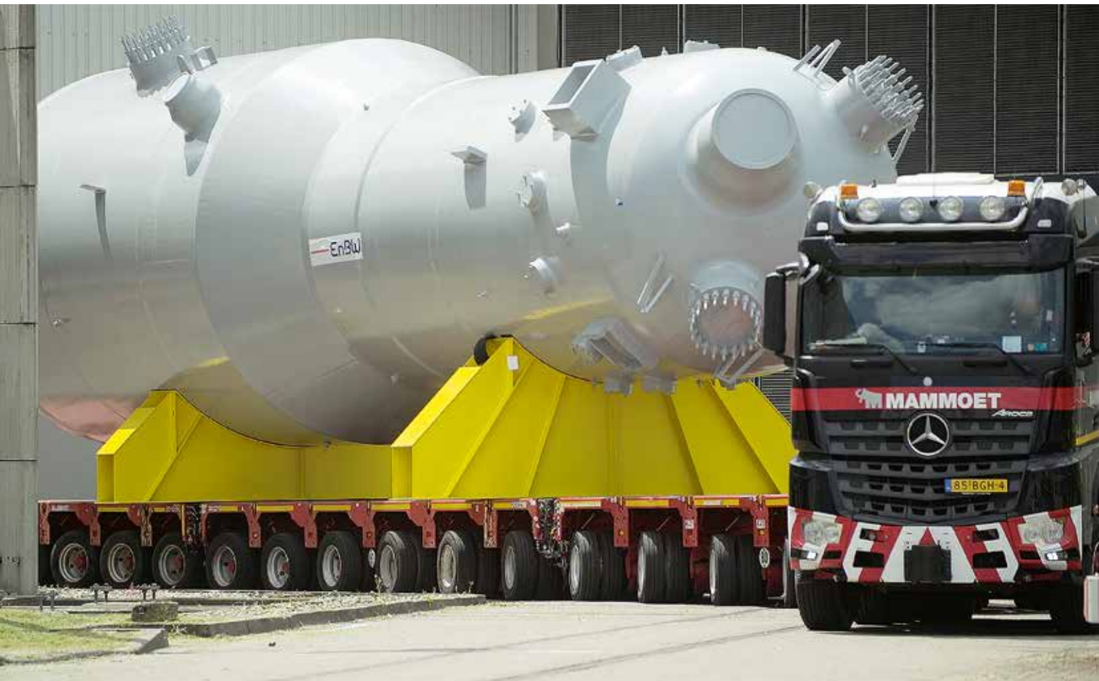
Transport eines Dampferzeugers zur Abstellfläche auf dem Kraftwerksgelände.
