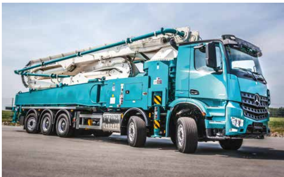
Mit schwerer Betonpumpe bestückter Fünffachser von Paul.
