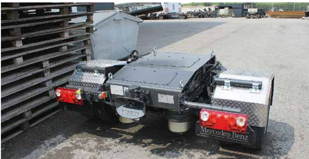
Diese modulare, koppelbare Achse fertigt Titan, um damit aus einem vier- einen fünfachsigem Actros zu erstellen.
