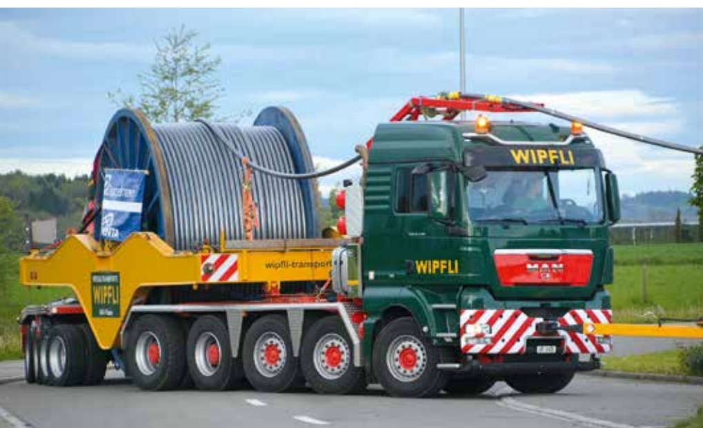
MAN TGX 53.540 als 5-Achs-Sattelzugmaschine mit 10x4/6-Antrieb. Foto: Toni Maurer GmbH & Co. KG
