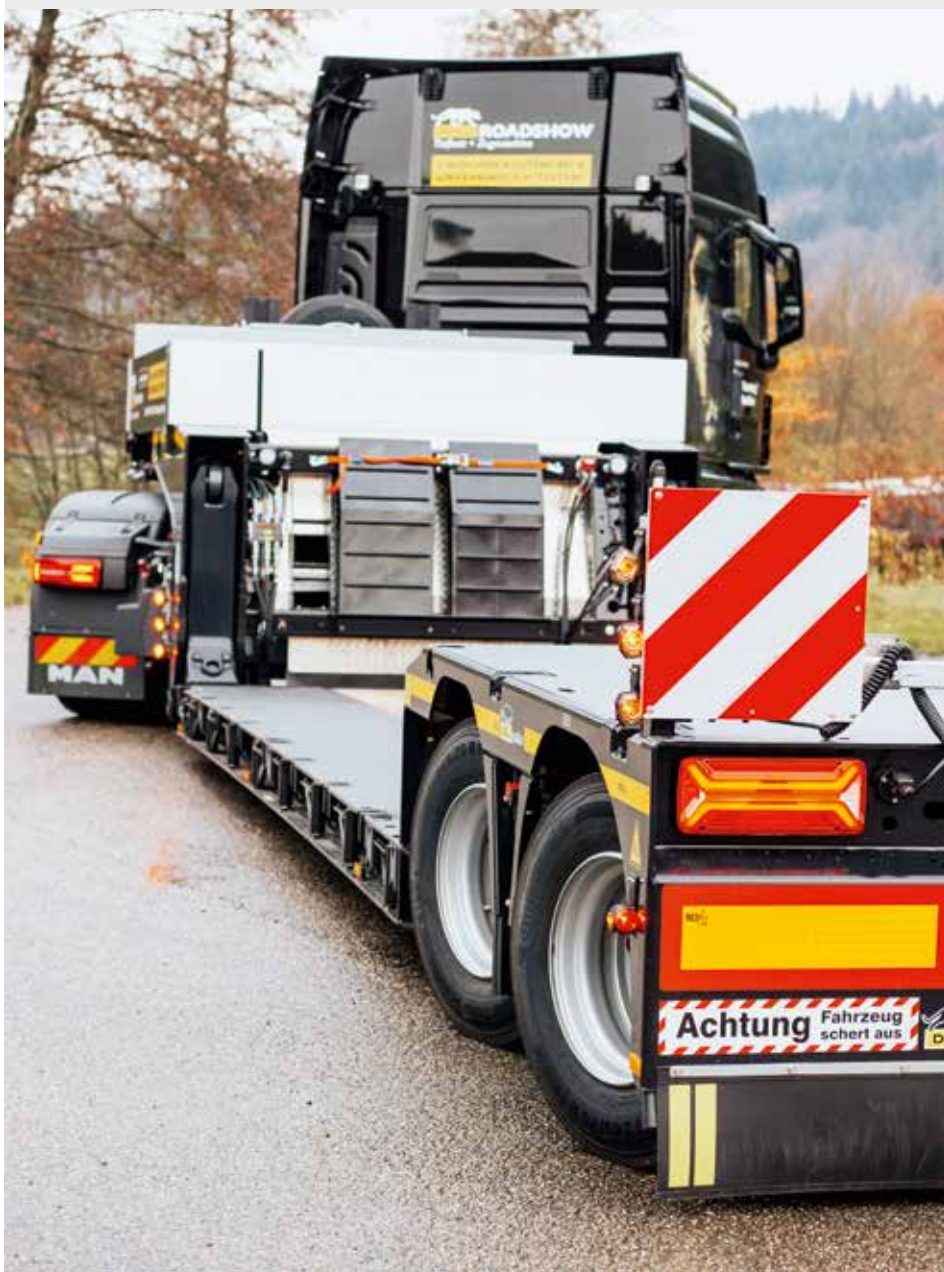
Das hydraulisch gefederte und gelenkte panther-Fahrwerk bietet 315 Millimeter Gesamthub und bis 55 Grad Lenkeinschlag.
