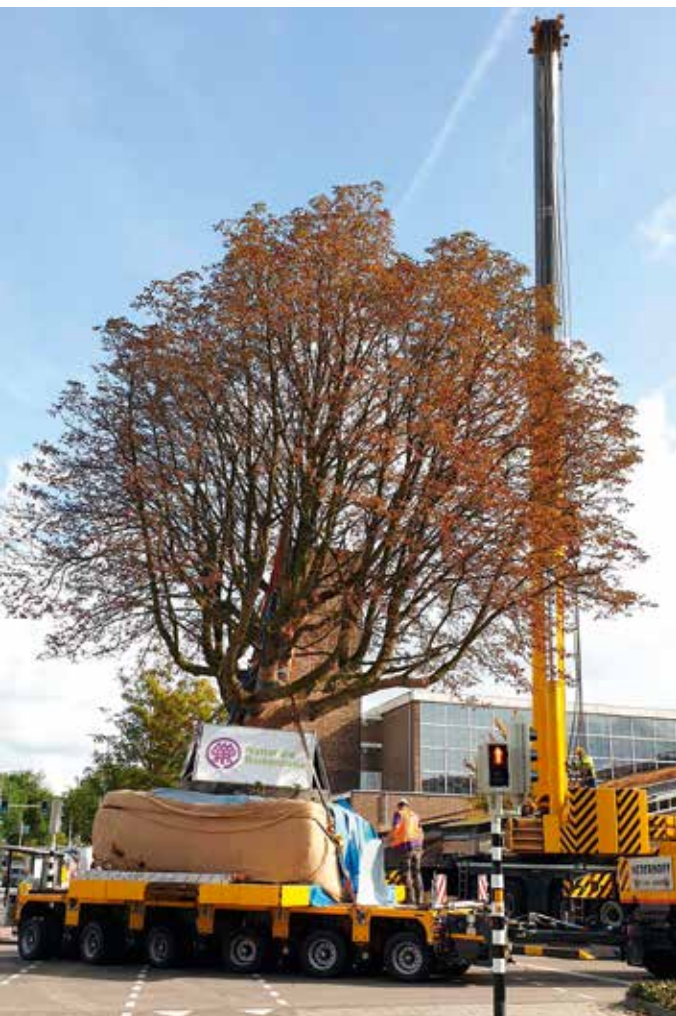
Mithilfe eines Krans wurde die Kastanie sicher auf den Modul-MAX gehoben.
