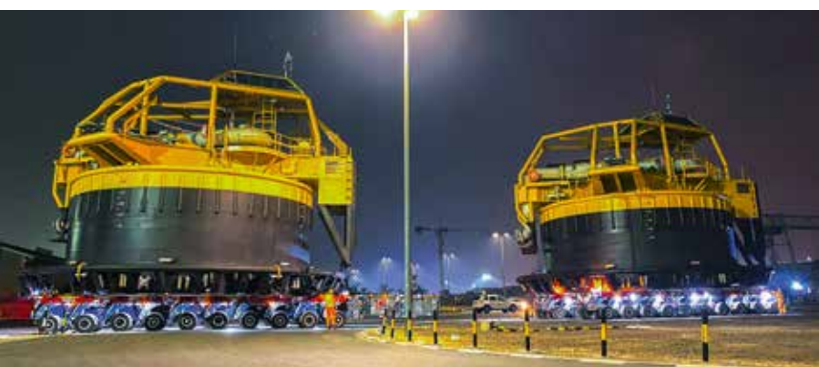
Der Doppelkonvoi mit den zwei CALM-Bojen bewältigte die 2,5 Kilometer lange Strecke innerhalb einer Nacht.
