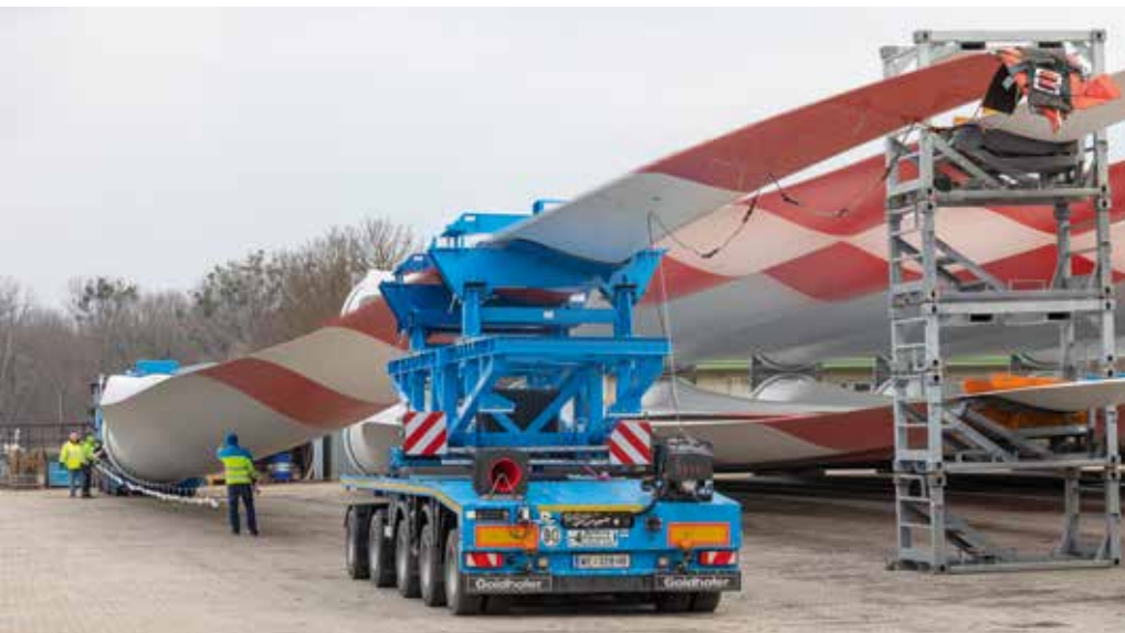
Nach dem Verladen des Rotorblattes und der Ladungssicherung werden noch die Versorgungsleitungen für den Nachläufer installiert.
