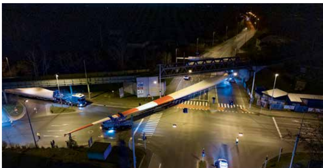
Mit dem Nachläuferkonzept sind auch enge Kurvenradien zu bewältigen.
