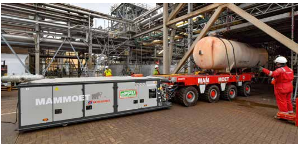
... und wird herausgefahren. Dabei dient die ePPU-Einheit als Gegengewicht.
